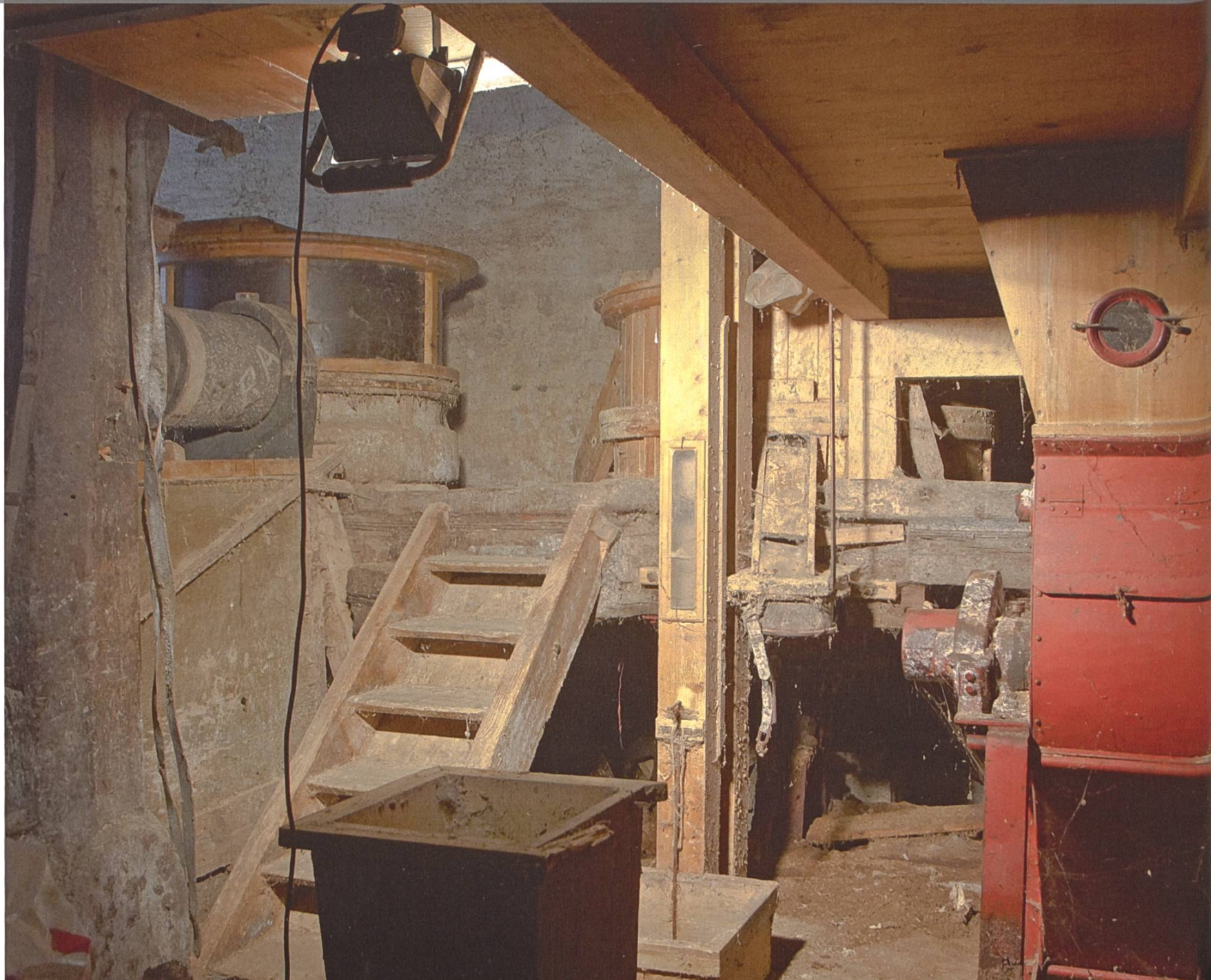
Zeglingen, Untere Mühle. Blick in den Mühlraum mit Mahltisch, Röllgang und Sichtertrichter.
