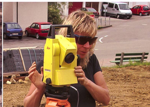
Sabine Bugmann, Restauratorin und Ausgräberin mit Spezialkenntnissen: hier beim Fundeintimmen mit Lasertachymeter und Spezialbrille.
