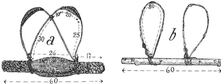
Ein solcher Tragknebel läßt sich im Walde mit Hilfe eines Messers in einfachster Weise erstellen. Ein etwa 60 cm langer Ast von circa 3 cm Dicke wird
