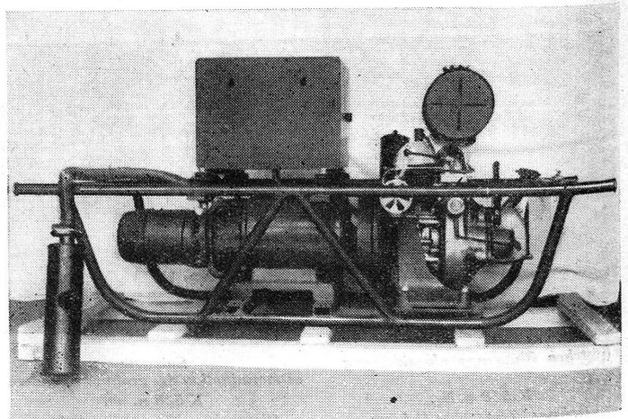
Generatoraggregat für Röntgenapparatur.
