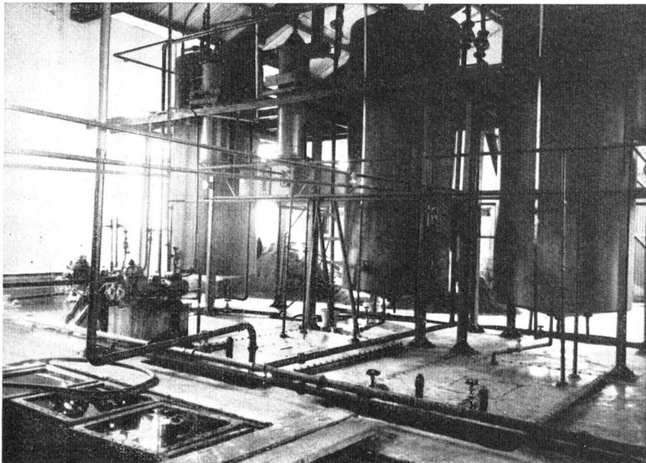
*Die in Reihen aufgestellten grossen Behälter sind die Extraktionsapparate für die pulverisierte Chinarinde.*
