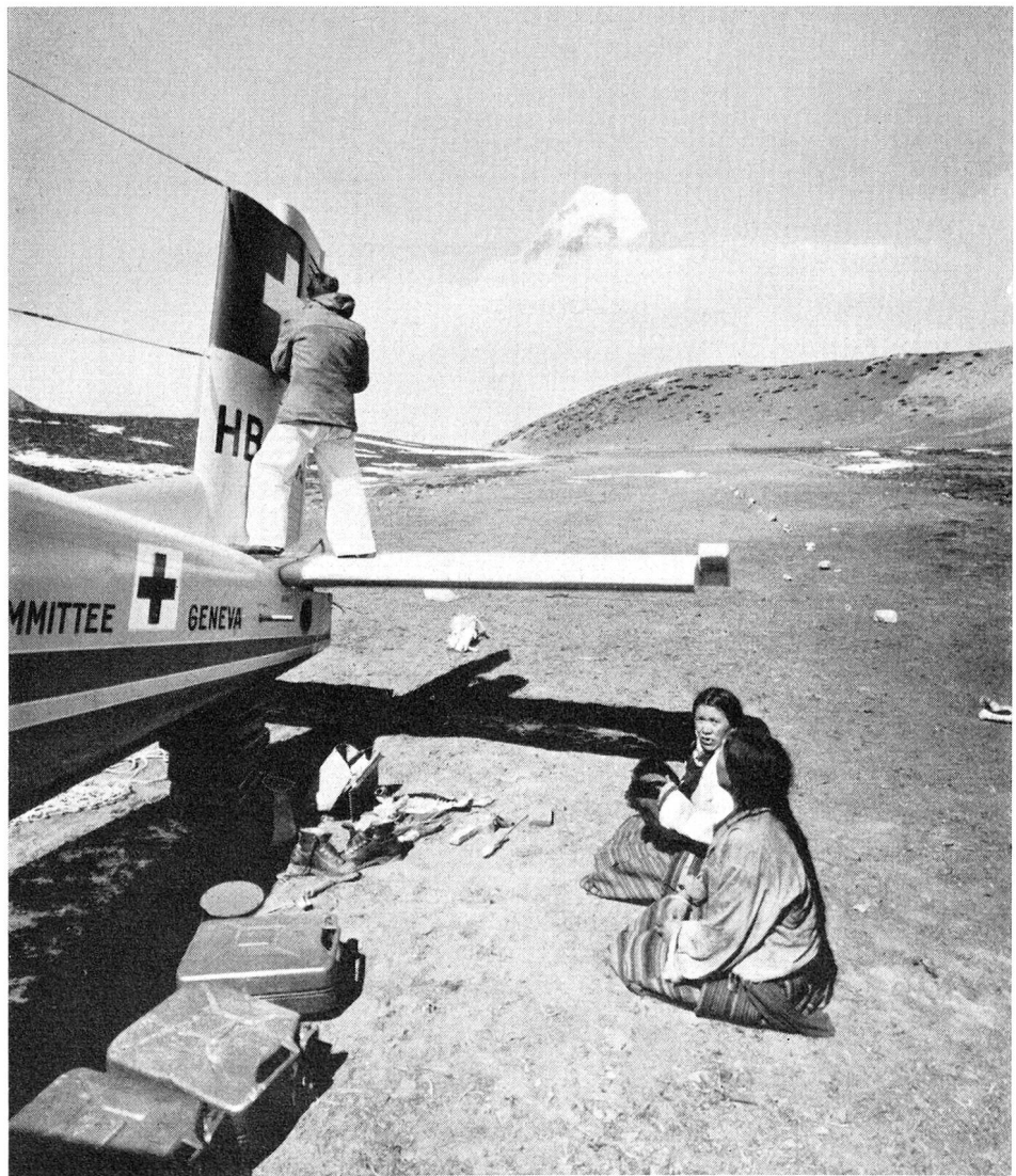
Bald darauf setzt sich das erste Rotkreuzflugzeug auf der neuen Piste ab. Unser Bild: Der Schweizer Pilot Hermann Schreiber repariert auf dieser Piste von Mingbo, dem wohl höchstgelegenen Flugplatz der Erde, das beschädigte Seitensteuer des Rotkreuz-Pilatus-Porters. Fotos Dr. Toni Hagen.
