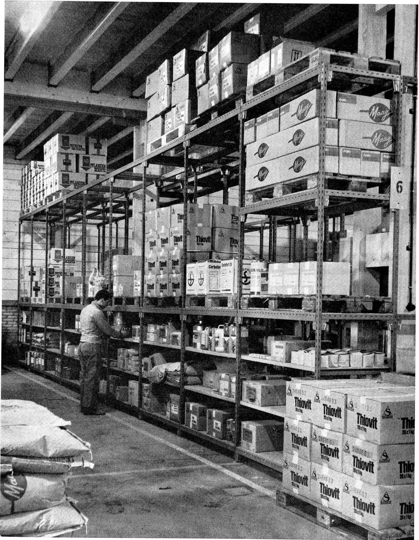
Beispiel Nr. 6: Kombinierte Palett-Lagergestell-Anlage, Höhe 4 Meter, Belastung pro Palett 1 Tonne
