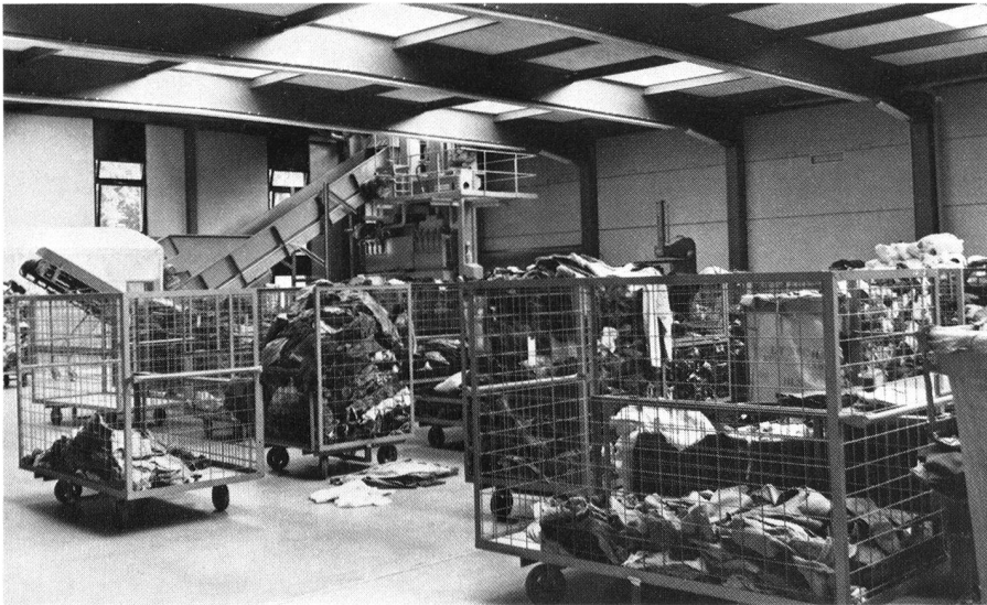
Sortierte Ware, zum Pressen bestimmt. Im Hintergrund das Förderband zur Presse.
