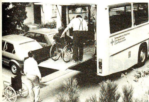
**Einer der drei SRK-Cars für Behinderte: Eine spezielle Hebeeinrichtung für Rollstühle erleichtert das Ein- und Aussteigen. (Bilder: SRK)**
