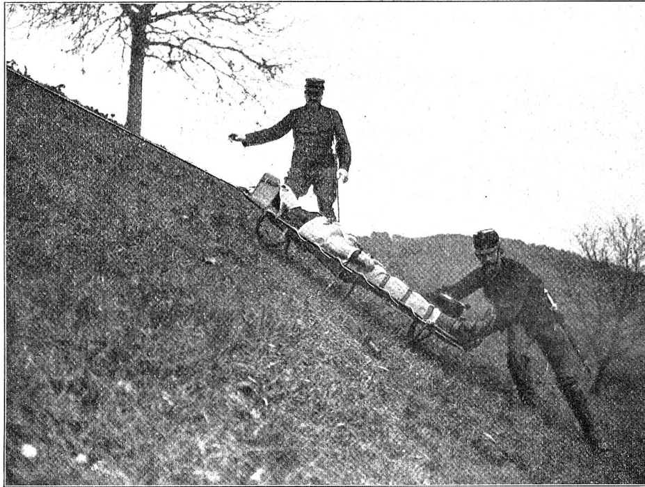
Fig. 1. Le traîneau-brancard du D r Lardy. Essais faits à une école de recrues des troupes sanitaires.
