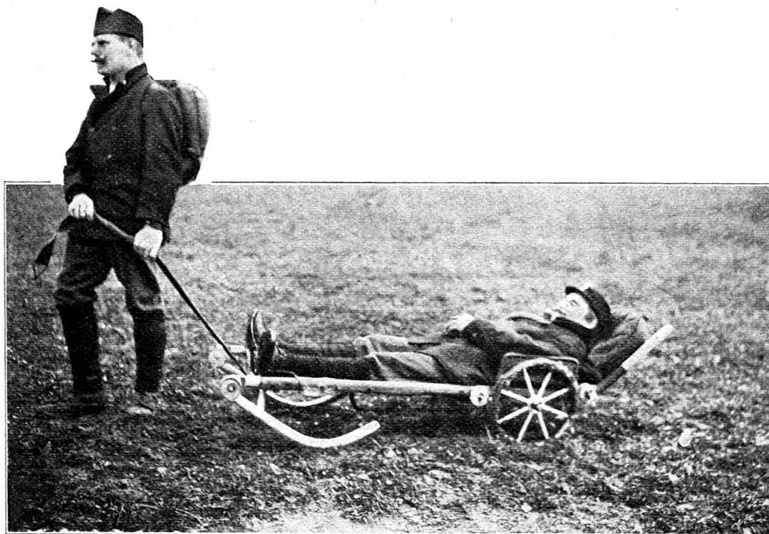
Fig 5. Transformé en traîneau, le brancard Riggenbach peut être tiré par un seul homme.
