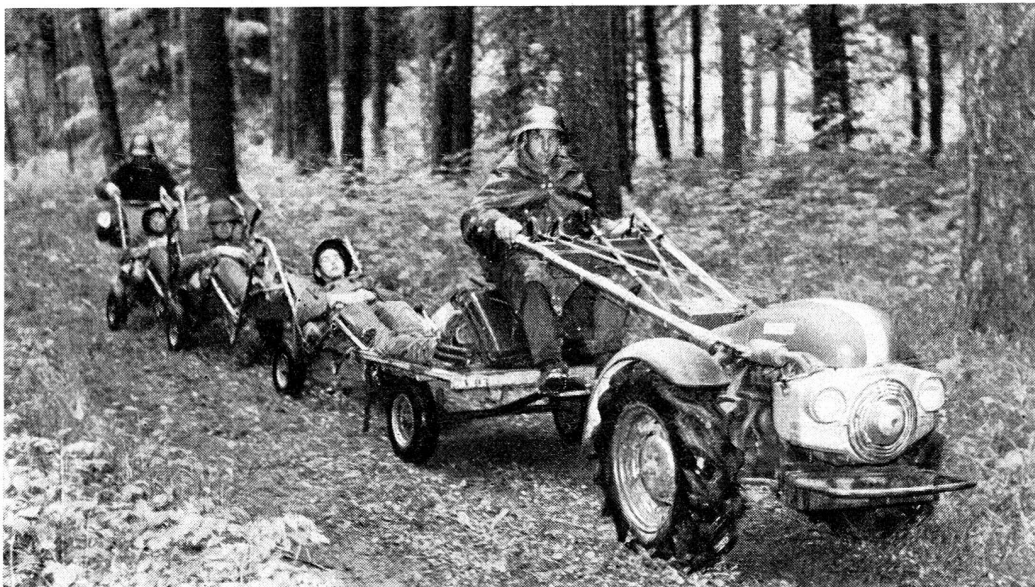
Au cours des récentes manœuvres sanitaires qui se sont déroulées en Suisse, on a utilisé ces petits tracteurs qui permettent de convoyer à proximité des lignes ou sous bois de véritables trains de brancards.
