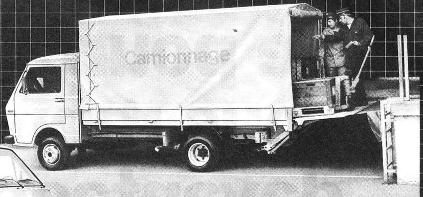
Le **VW LT** existe en versions fourgon, commerciale ou bus, à plateau, à double cabine ou châssis nu pouvant recevoir les carrosseries spéciales les plus diverses. A essence, diesel et turbo diesel.
