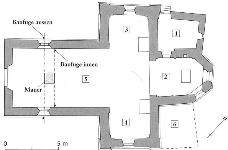
baut. Die Steinplatten des Mittelganges wurden entfernt und die darunter liegende Schuttschicht bis zu 30 cm abgetragen. In diesem Bereich konnte eine gemörtelte Bruchsteinmauer gefasst werden (Abb. 55). Die Ost-West orientierte Mauer weist eine Breite von 90 cm auf. Ihre Aussenflucht liegt auf einer Linie mit den oben beschriebenen Baufugen im aufgehenden Mauerwerk. Damit konnten die Resultate der Bauuntersuchung durch den Mauerbefund im Boden bestätigt werden.
