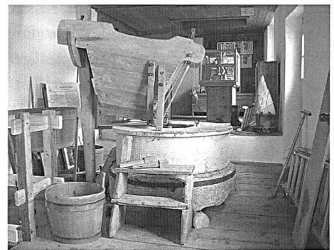
Abb. 149: Sta. Maria V. M., Mühle Mall, Erdgeschoss. Mahlgang mit Läufer- und Bodenstein, darüber der Einfülltrichter.
