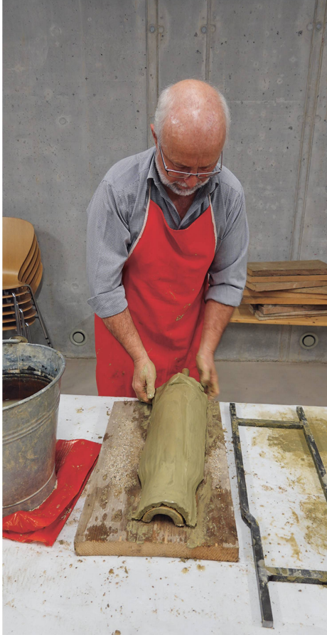
Abb. 3: Cham/Hagendorn ZG, Ziegelei-Museum. 2021. Jürg Goll bei den ersten Versuchen zum Formen eines Hohlziegels.
