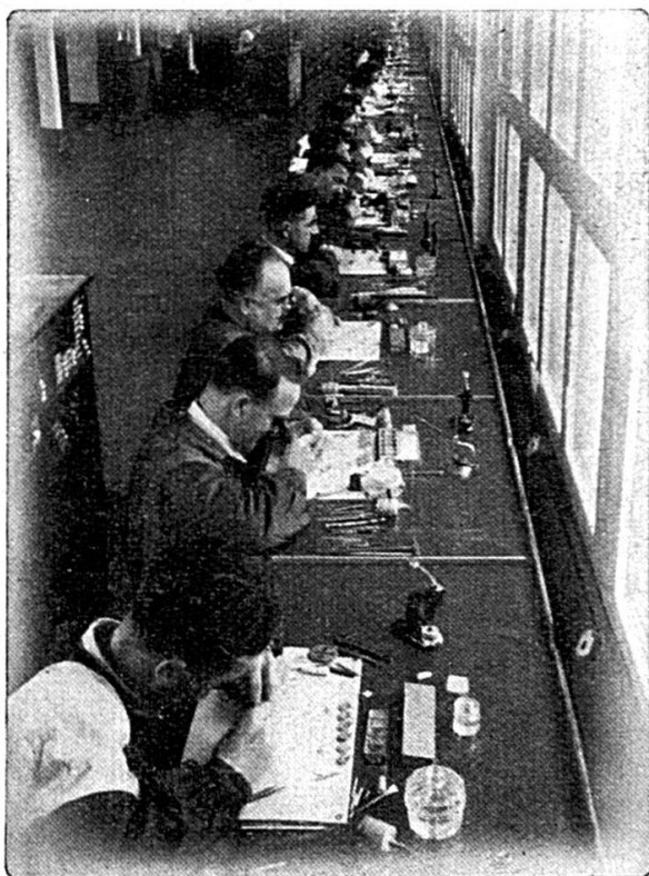
Atelier de remontage d'échappement
