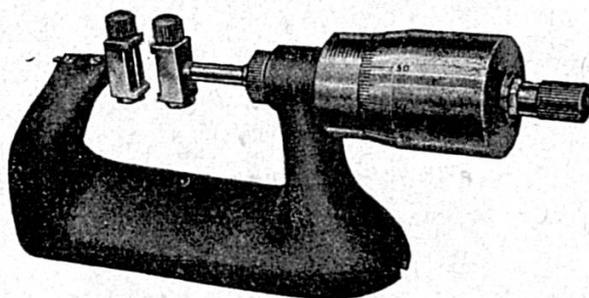
MICROMÈTRE pour mesurer les diamètres
