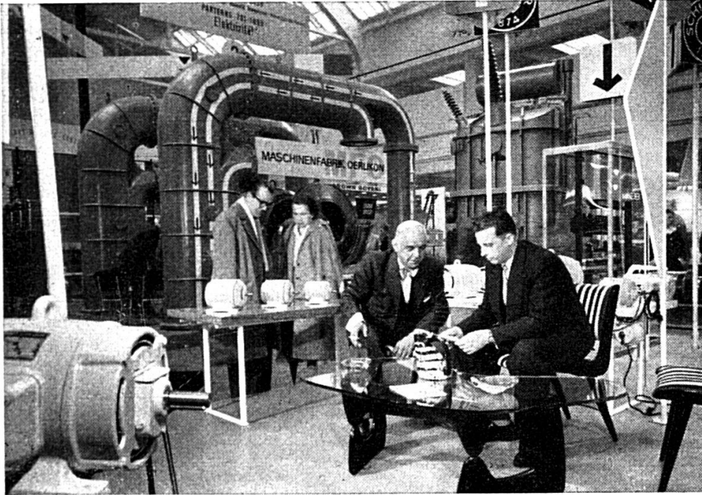
L'industrie électrique et la construction mécanique. A l'arrière-plan, à gauche, une soufflante centrifuge pour l'extraction du fluide gazeux d'un réacteur atomique ; à droite, un transformateur monophasé faisant partie d'un groupe triphasé de 120 000 kVA
