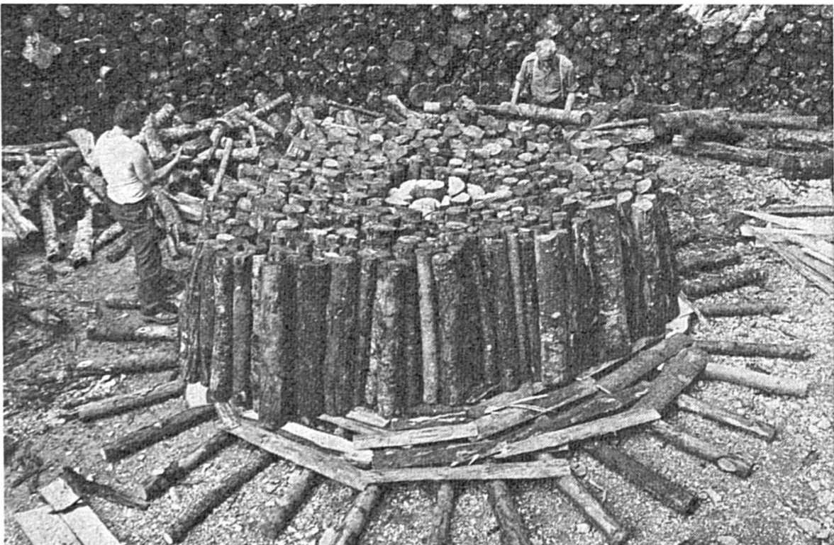
Les charbonniers construisent le premier étage. Au centre, les rondins blancs constituent la cheminée.
