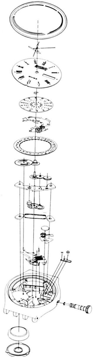
du cadran. Les manipulations s'effectuent au moyen d'une tige de mise à l'heure classique à trois positions; la deuxième position permet de corriger rapidement les jours et les dates.
