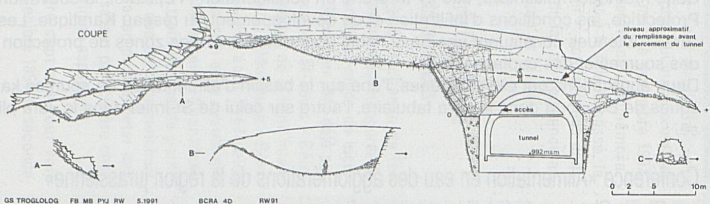
La construction d'une autoroute en milieu karstique implique que des mesures soient prises pour protéger les eaux souterraines : l'imperméabilisation des chaussées ainsi que la récupération des eaux de route visent à éviter tout impact aux sources situées à l'aval du projet (turbidité, hydrocarbures, etc.). D'autre part, la rencontre d'un vide karstique (grotte), tout attrayant qu'il soit pour les spéléologues, peut poser des problèmes ardues aux constructeurs.
