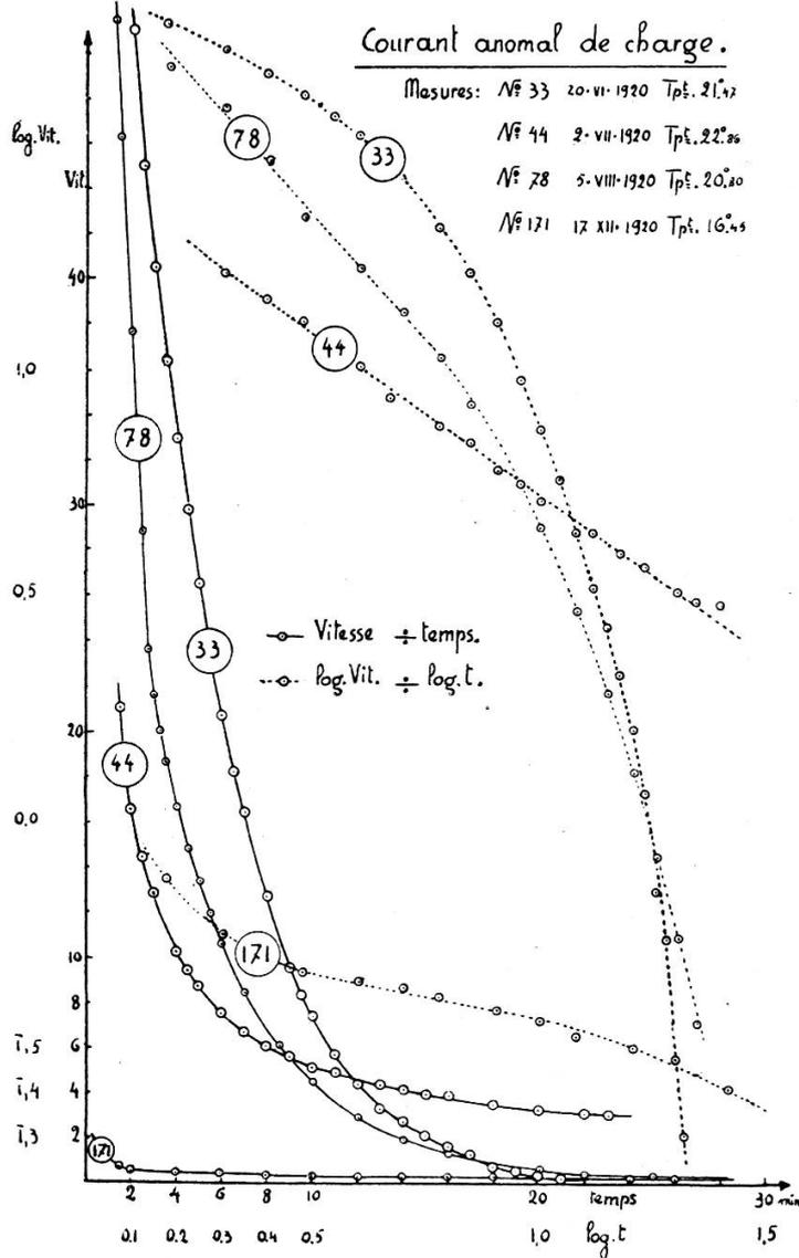
rythme de l'intensité du courant anomal (log. vit.) en fonction du temps. Dans le cas d'une exponentielle, on obtiendrait une droite; or la courbe II, *diagramme II*, donne seulement à partir de la douzième minute environ une portion rectiligne. Mais rien n'empêche de supposer le phénomène plus complexe et d'essayer de le représenter par la superposition de deux fonc-
