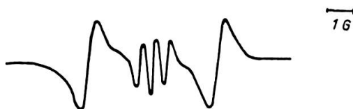
Signal de résonance des protons dans le mélange H_2O + D_2O adsorbé dans l'édingtonite (dérivée de l'absorption en fonction du champ magnétique).
