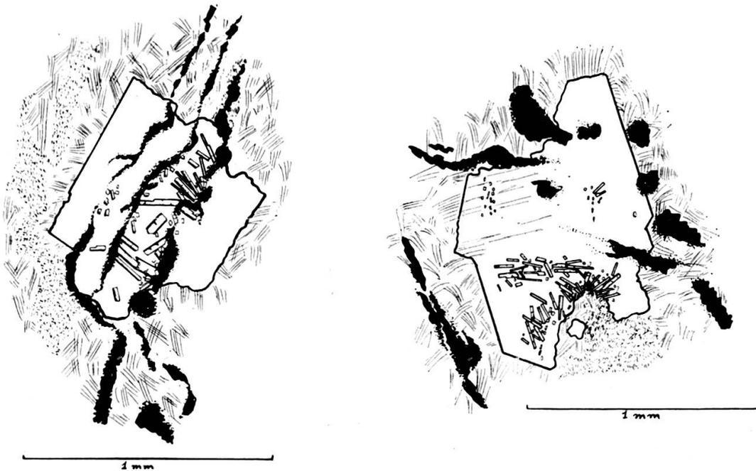
FIG. 2 (pl. m. 2 V). Lum. nat. — Phénoblaste d'albite dans « fond » finement phylliteux, avec traînées de minéraux semi-opaques (leucocoxène) et prismes épidotiques (Matrice de coussin presque « intact », Prainan).
