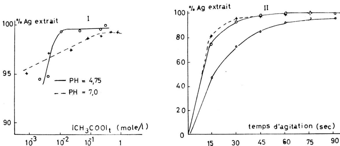
FIG. 10. — Extraction de l'argent en milieu complexant acetate.
