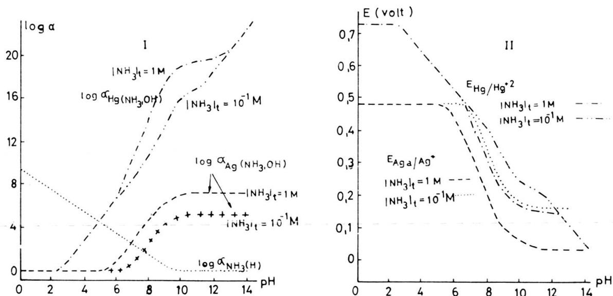
FIG. 19. — Echange redox argent-mercure en milieu complexant ammoniacal.
