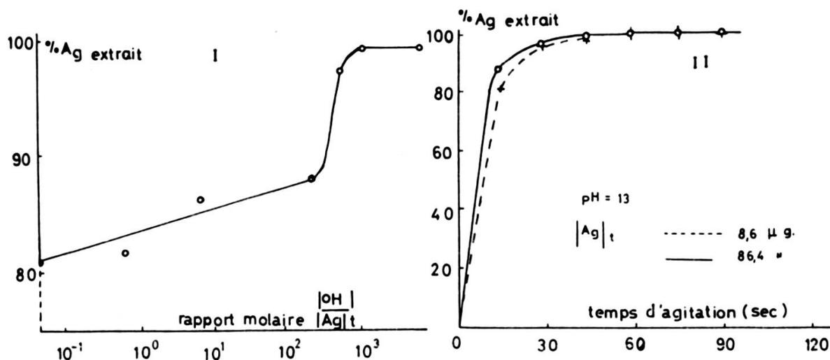
FIG. 4. — Extraction de l'argent en milieu complexant hydroxyle.
