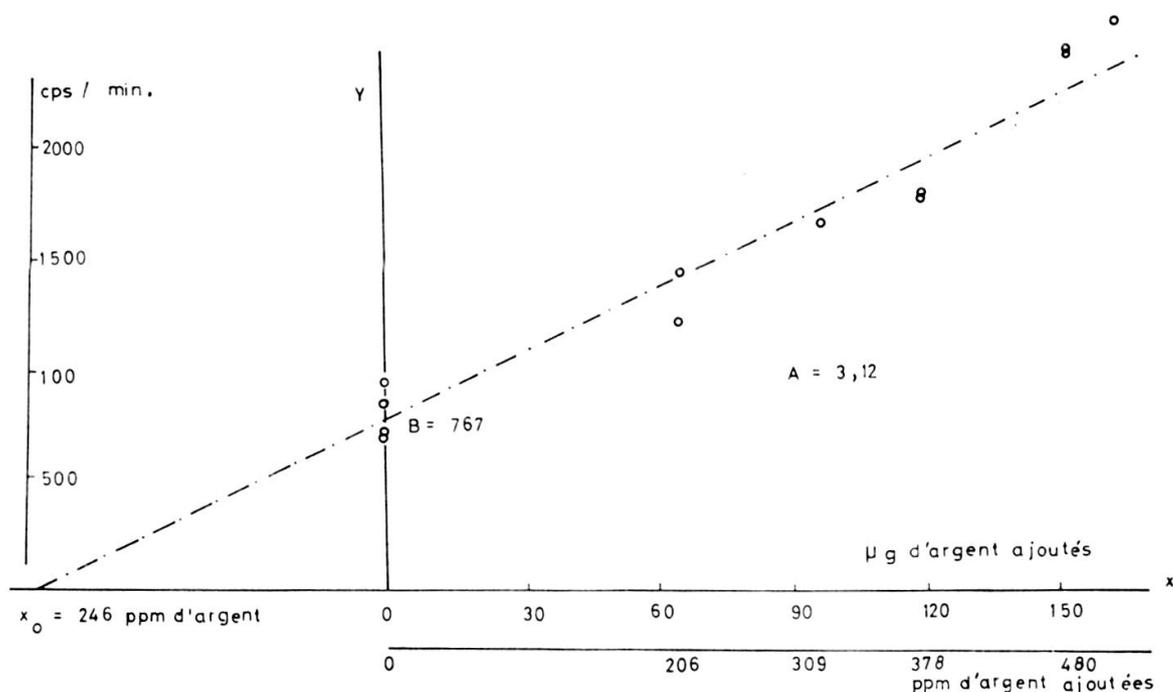
FIG. 28. — Dosage de l'argent dans une galène par activation aux neutrons thermiques
