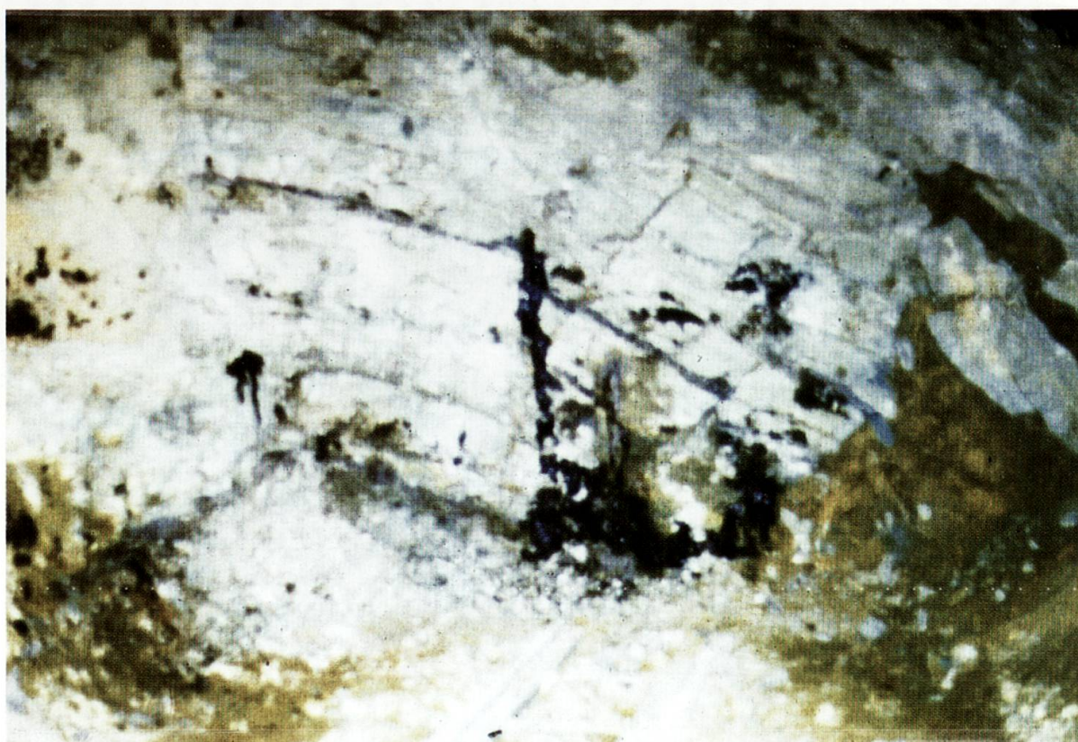
PHOTO n° 1. Galerie karstique anté-oligocène dans les calcaires hauteriviens remplie par les argiles rouges de la Gompholite. Les traces de pétrole sont nombreuses dans cette zone.
