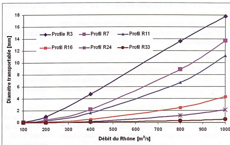
quées en 2003 (voir figure 2). Les résultats montrent que la phase de chasse (48h-88h) permettrait de mobiliser des matériaux de diamètre inférieur à 30-40 mm sur l'ensemble de la retenue. La grande majorité du gravier arrivant de l'Arve serait ainsi susceptible de transiter par la retenue de Verbois durant les chasses. La fraction grossière de ces graviers serait cependant stockée à la Jonction.
