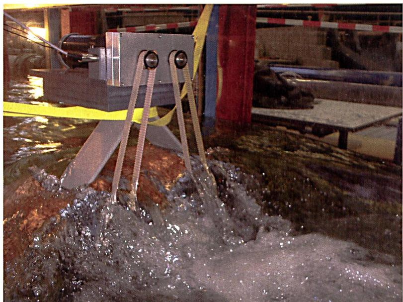
Fig. 8: Chute créée par l'impact du modèle sur la courbe de remous.
