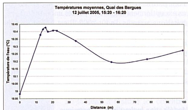
Fig. 2: Températures moyennées verticalement enregistrées le long du Quai des Bergues. Le pic de température vient juste après le rejet n° 5. Le point 0 correspond au Pont du Mont-Blanc.
