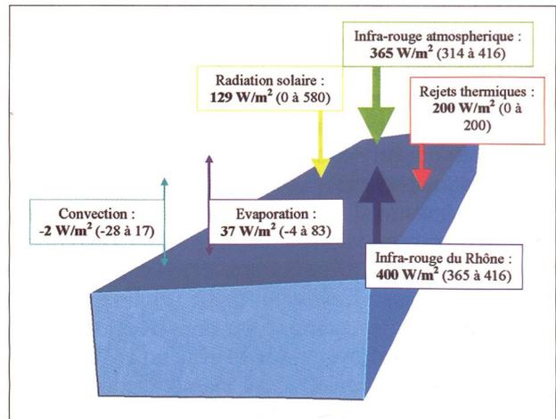
Fig. 5 (a): Flux énergétiques sortant et entrant du fleuve. Le bilan de ces flux donne un effet global d'échauffement ou de refroidissement.
