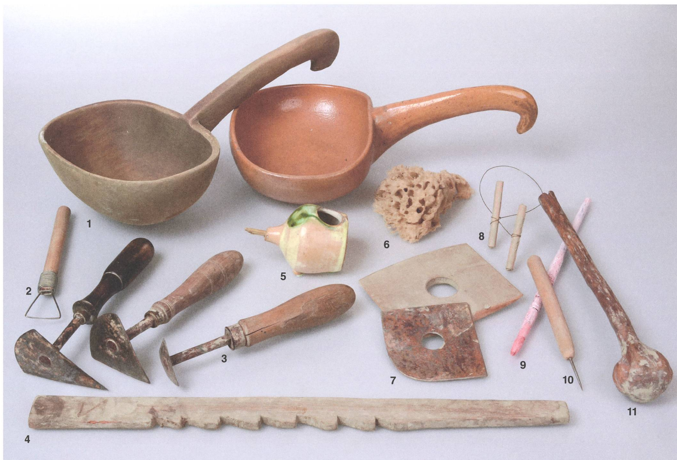
Abb. 89: Auswahl typischer Hafnereigerätschaften des 19. Jahrhunderts: 1 Glasurkellen; 2 Abdrehschlinge; 3 Abdreheisen; 4 Stichmass; 5 Malhorn; 6 Schwamm; 7 Töpferschienen; 8 Abschneidedraht; 9 Pinsel; 10 Kritzer; 11 Drehhilfe für kugelbauchige Objekte.
