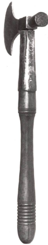
Abb. 7. Der Bleihammer der Abbildung 6 in schräger Seitenansicht. Deutlich erkennt man seine kreisrunde Bahn, deren Durchmesser 19 mm beträgt. Foto: Azzola
