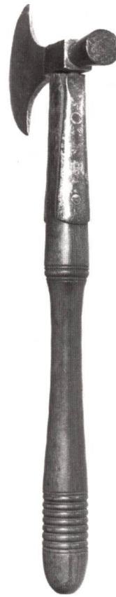
Abb. 7. Der Bleihammer der Abbildung 6 in schräger Seitenansicht. Deutlich erkennt man seine kreisrunde Bahn, deren Durchmesser 19 mm beträgt. Foto: Azzola
