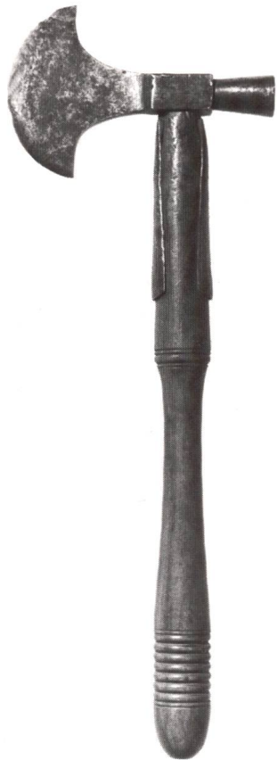
Abb. 6. Ein weiterer Bleihammer in Seitenansicht. Sein Stiel ist insgesamt 30,3 cm lang, das Arbeitsteil 118 mm hoch und der Halbmond bis 78 mm breit. Foto: Azzola
