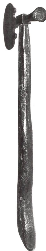
Abb. 4. Der Bleihammer der Abb. 3 in schräger Seitenansicht. Deutlich erkennt man seine kreisrunde Bahn, deren Durchmesser 23 mm beträgt. Foto: Azzola
