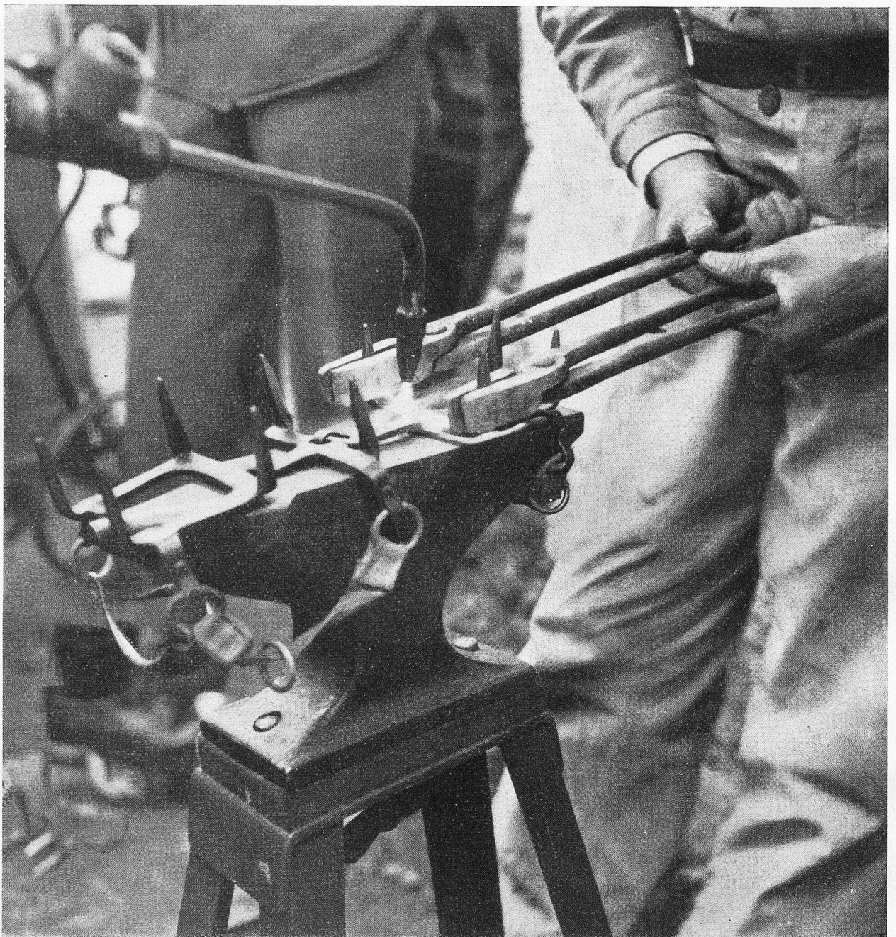
Die Steigeisen müssen mit Zange und Schweissbrenner genau dem Schuh angepasst werden, damit man sich im Eis auf sie verlassen kann.
