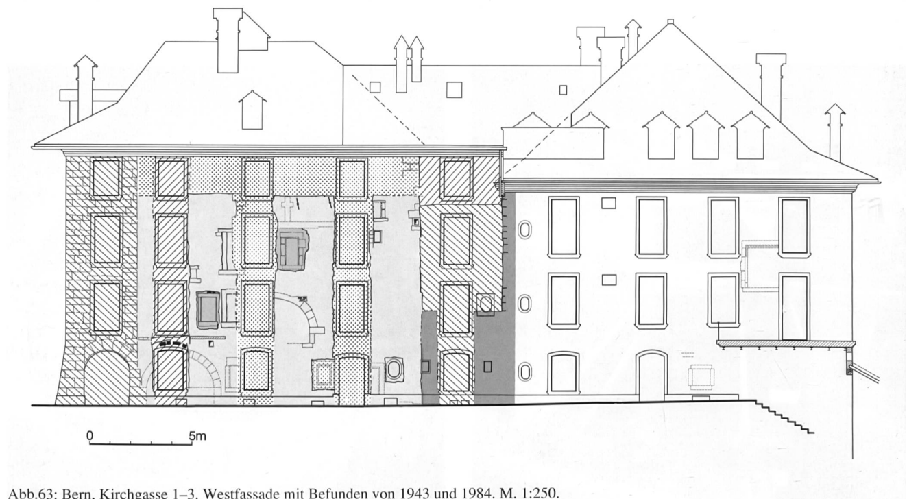
Abb.63: Bern, Kirchgasse 1–3. Westfassade mit Befunden von 1943 und 1984. M. 1:250.
