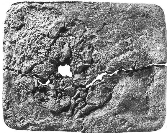
Abb. 7: Bern-Engelhalbinsel - Thormebodewald. Unbearbeitete Rückseite des Zinktäfelchens. Die Oberfläche ist klüftig und zeigt ein typisches Erstarrungsgefüge an offener Luft. Das kleine fehlende Stück in der Mitte ist gut zu erkennen.
