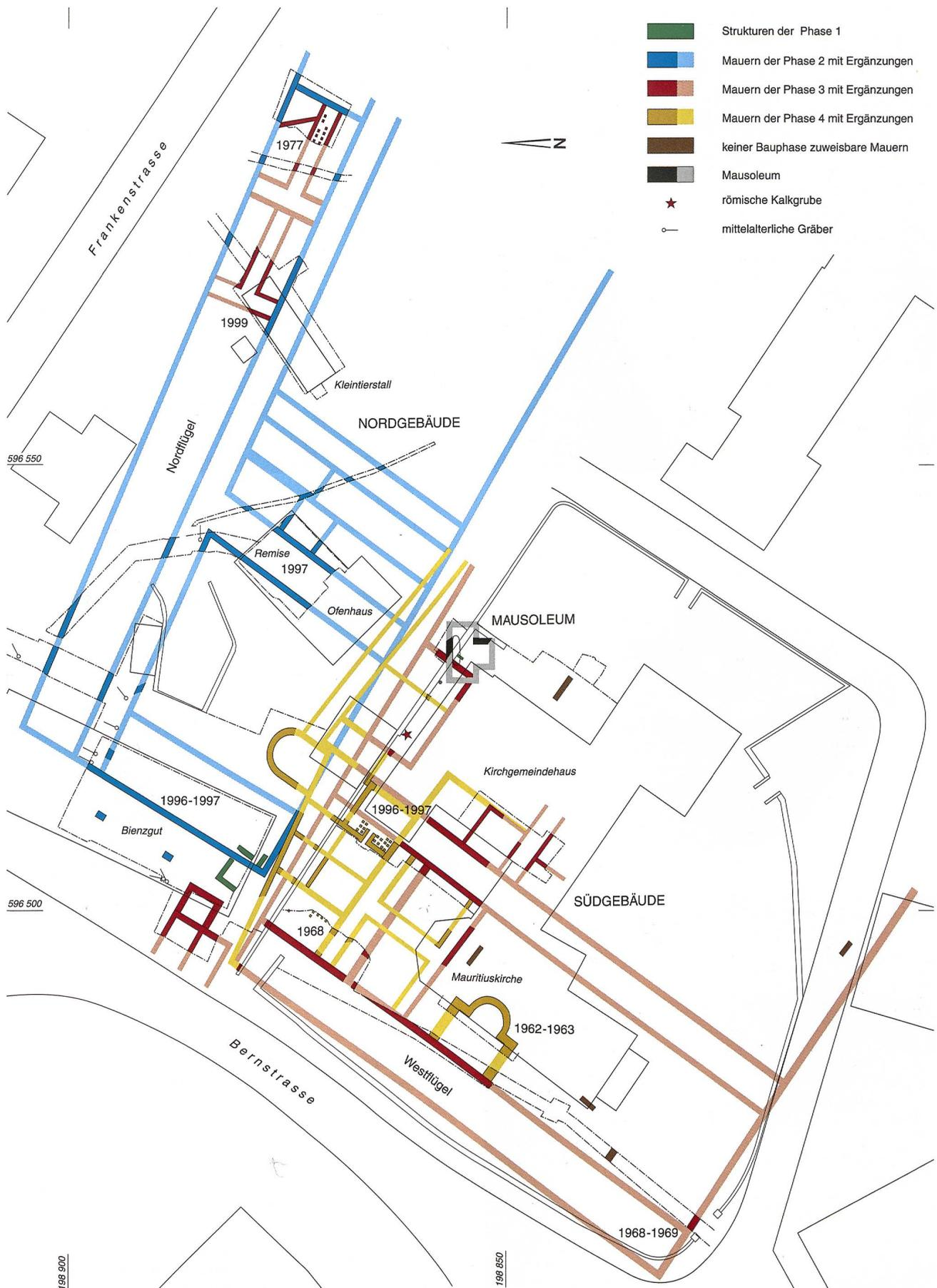
Abb. 215: Bern-Bümpliz - Kirche (Biengut/Kirchgemeindehaus) Übersichtsplan mit allen römischen Mauern. Die Phasen 1 und 2 betreffen vor allem den Nordflügel der Villa. Die Phase 3 bringt den Neubau des Westflügels, die Phase 4 Umbauten in beiden Gebäudeteilen. M. 1:600.
