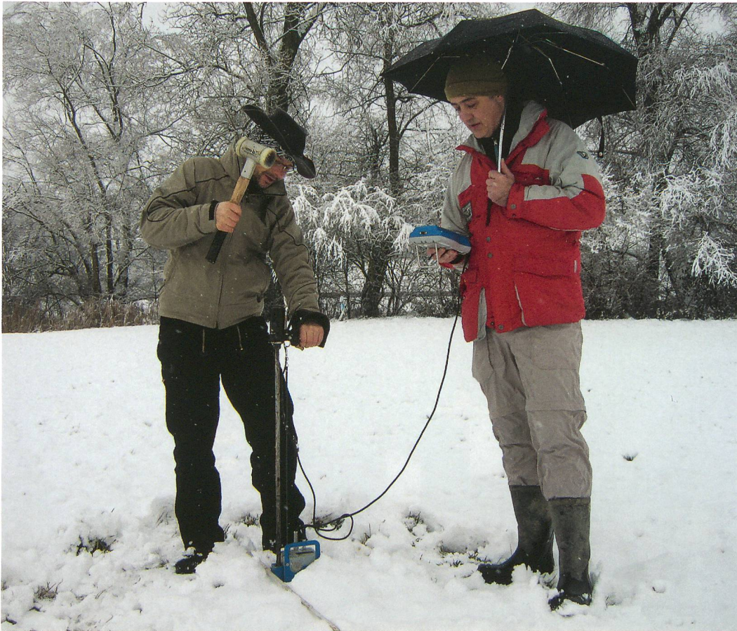
Abb. 2: Seedorf, Lobsigensee. Luzius Matile und Marco Achermann führen im Rahmen von bodenkundlichen Untersuchungen Messungen mit einem dynamischen Penetrometer (PANDA-Sonde) aus. Anhand der gemessenen Eindringwiderstände können dichtere (mineralische/antorfige) und lockere Schichten (Torf) im Bodenprofil lokalisiert und in Zusammenhang mit dem Abbauzustand am untersuchten Standort gebracht werden.
