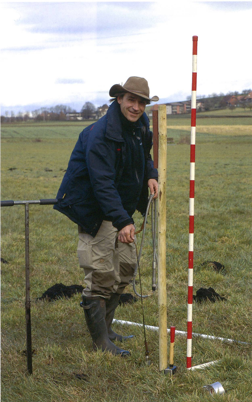
Abb. 1: Seedorf, Lobsigensee. Roland Haab beim Setzen einer Piezometer-Sonde zur permanenten Messung des Grundwasserstandes.
