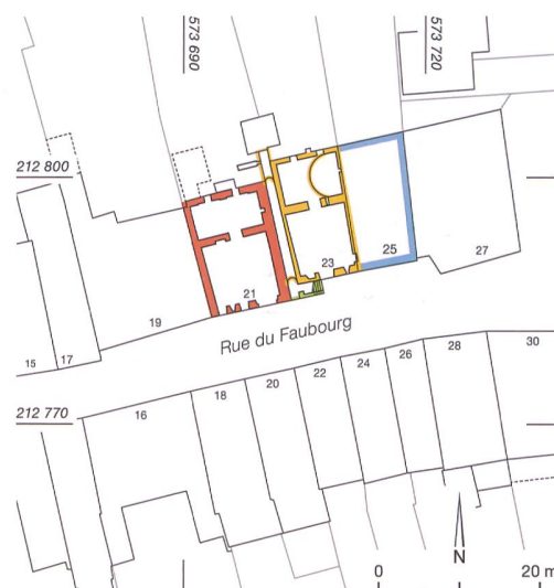
Fig. 3 : La Neuveville, Rue du Faubourg 21-25. Plan des maisons n° 21 (phase rouge) et n° 23 (phase jaune), ainsi que la base de la façade sud du n° 25 (phase bleue) et l'escalier d'accès (phase vert clair). Ech. 1:1000.
