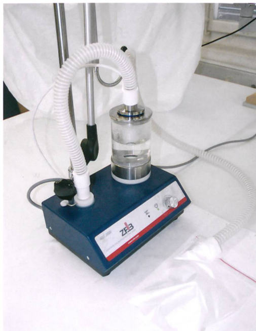
Abb. 8: Ein Klebstoff-Aero- sol wurde mithilfe eines Ultraschallverneblers auf den getrockneten Bast- schuh appliziert.
