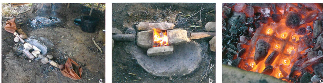
Abb. 15: Rekonstruierter Schmelzofen mit zwei sich gegenüberliegenden Düsenziegeln, welche über Holzrohre und Lederblasebälge belüftet werden. Der Ofen befindet sich in einer leichten Senke, die mit Lehm ausgestrichen ist, die Wände bestehen aus mobilen Steinen. Die Tüpfelplatte befindet sich unter der glühenden Holzkohle und füllt den Ofenraum von etwa 15 × 20 cm beinahe aus. a Übersicht; b Nahaufnahme in Betrieb; c zusammengeschnitzene, noch flüssige Metallrohlinge.
