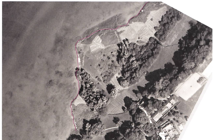
Abb. 3: Sutz-Lattrigen, Rütte. Die Uferlinie im Bereich der Fundstelle von 1947 (oben), projiziert auf ein Orthofoto vom Mai 2014 (unten). Der Uferrückgang an der Landspitze betrug rund einen halben Meter pro Jahr.
