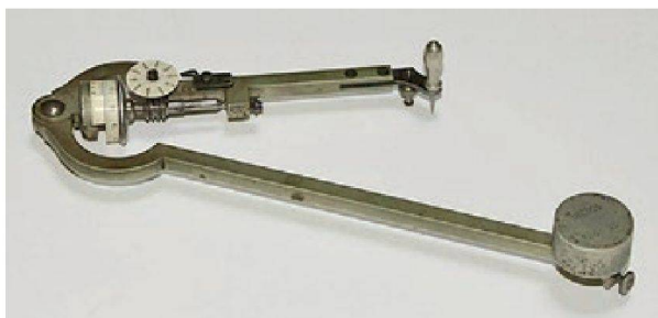
Abb. 22: Amsler Polarplanimeter zur Flächenmessung auf Plänen http://de.wikipedia.org/w/index.php?title=Datei:Amsler-Polarplanimeter-2.jpg&filetimestamp=20101108014100
