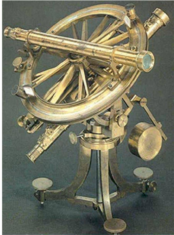
Abb. 36: Mit diesem Theodolit der Firma Kern Aarau führte General Dufour 1835 die erste Triangulation in der Schweiz durch.
