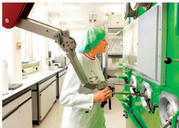
Abb. 34: Eine Laborantin steuert mittels eines Manipulators die Abläufe im Inneren einer mit Blei abgeschirmten Kammer, in der das radioaktive Medikament ^{90}\text{Y} -Zevalin® hergestellt wird. Bild: PSI.
