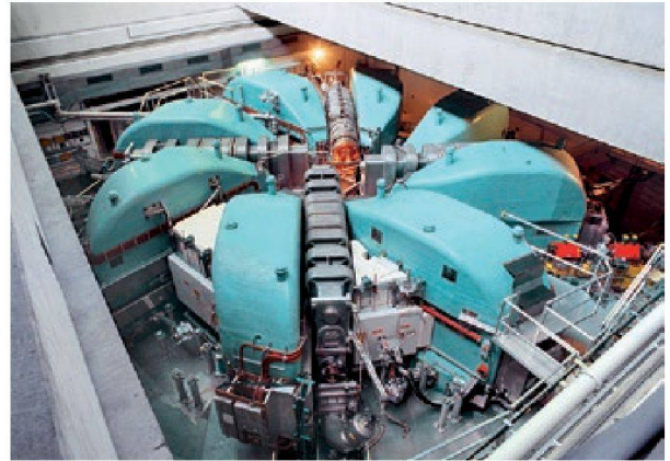
Abb. 8: Das historische Herzstück der Grossanlagenforschung am PSI: Der Protonen-Ringbeschleuniger. 8 Ablenkmagnete (blaugrün) halten die Protonen auf einer spiralförmigen Bahn. Die 4 Kavitäten (grau) beschleunigen die Protonen. Bild: PSI.
