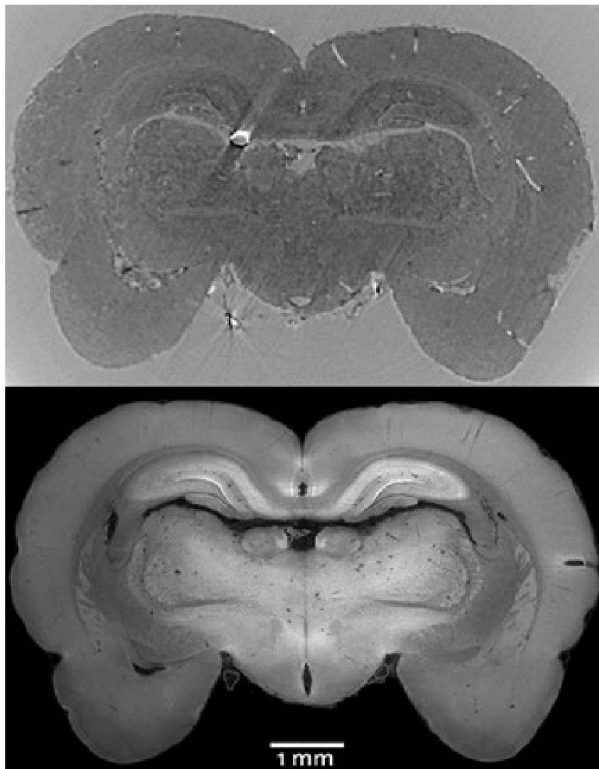
Abb. 17: Herkömmliche Röntgen-Tomografie eines Rattengehirns (oben) und neuartige Phasenkontrast-Röntgen-Tomografie (unten). Bilder: M. Stamparoni, PSI/ETHZ.
