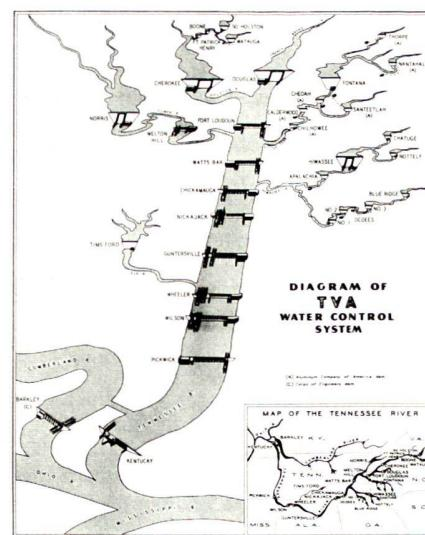
Im Einzugsgebiet des Tennessee Rivers sind über 30 grössere Staudämme gebaut worden. Für die Schifffahrt sind dazu auch die notwendigen Schleusenanlagen entstanden.
