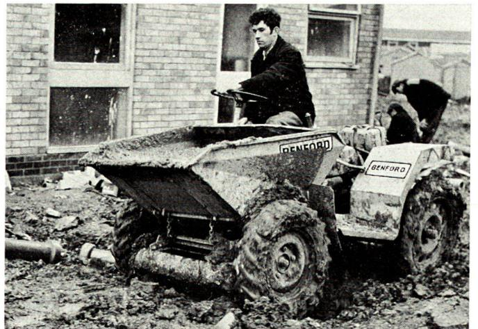
Zum Beispiel der kleinste universell einsetzbare Dumper, Modell DCP, mit 2-Rad-Antrieb, 7,5-PS 1-Zylinder Petter-Dieselmotor, mit mechanisch kippbarer Mulde, Inhalt 510 l, und einer Tragkraft von 1000 kg. Verlangen Sie eine unverbindliche Vorführung.
