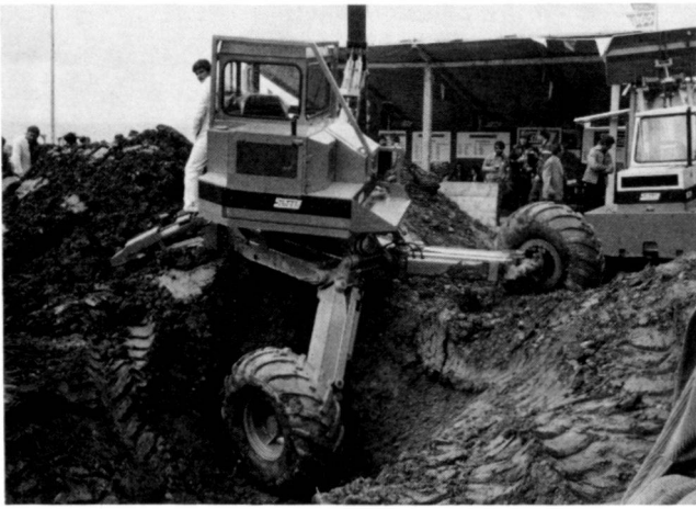
Schreitbagger im praktischen Einsatz an der öga.
