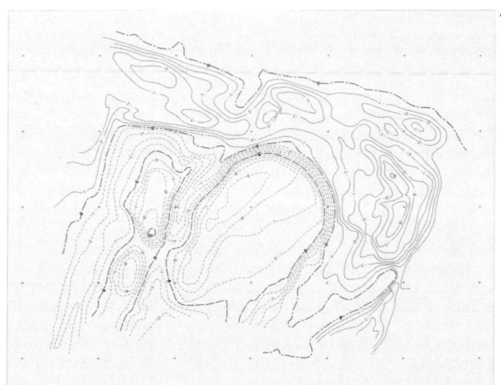
Abb. 2: Nullmessung (DGM 1): Topographische Aufnahme vor Beginn der Erdbewegungsarbeiten. Äquidistanz: 1 m.
