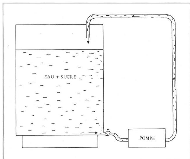
Schéma de principe d'un circuit fermé (pour la fabrication du sirop de sucre).
