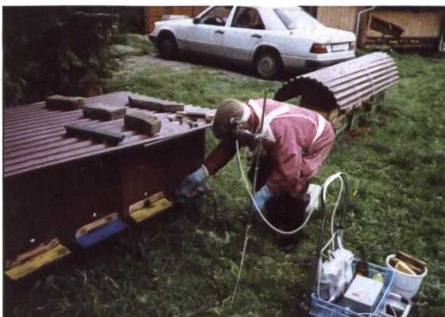
Illustration 5: L'apiculteur en train d'introduire l'évaporateur Varrox® par le trou de vol. Au premier plan, le capteur avec la tête de prélèvement. A droite la pompe à circulation pneumatique et l'appareil de mesure du volume.
